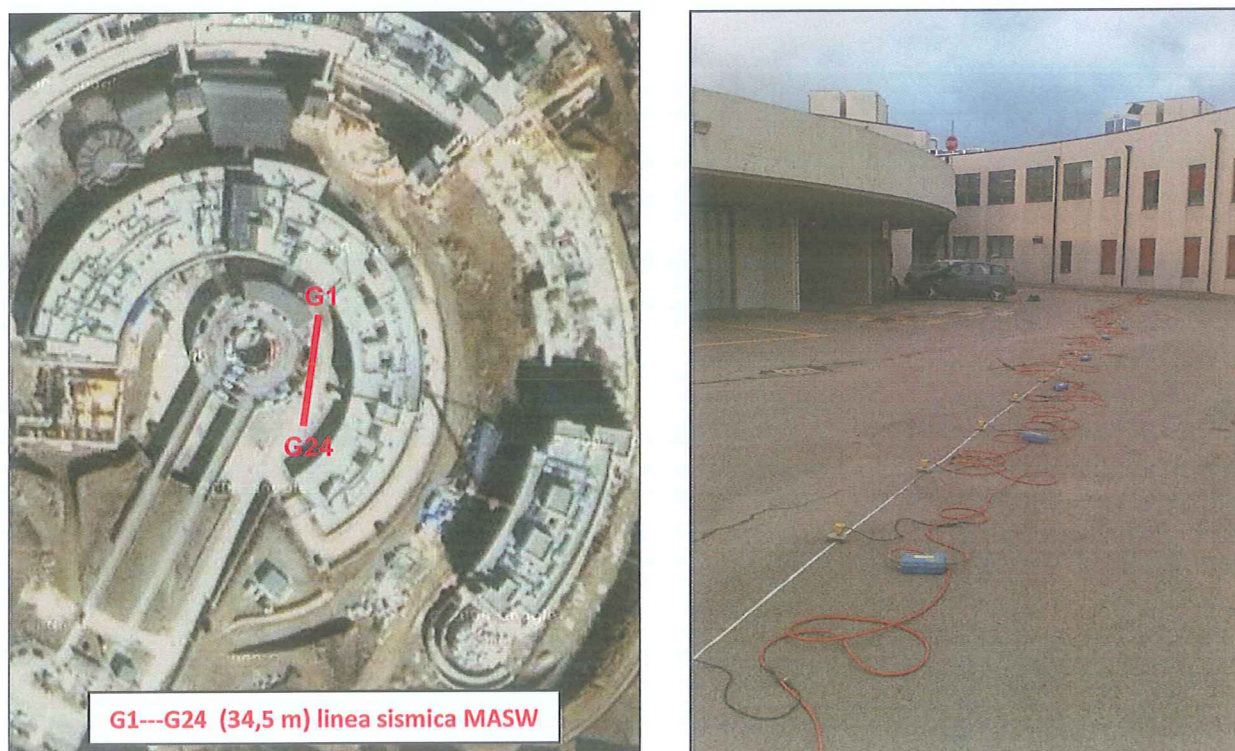
Fig.1: Ubicazione linea sismica masw
