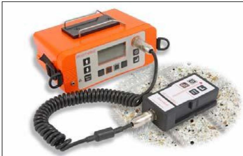
Il pachometro è uno strumento utilizzato per localizzare in modo rapido ed accurato la presenza e l'orientamento delle barre nel calcestruzzo armato e misurare con buona precisione lo spessore di copri ferro.
