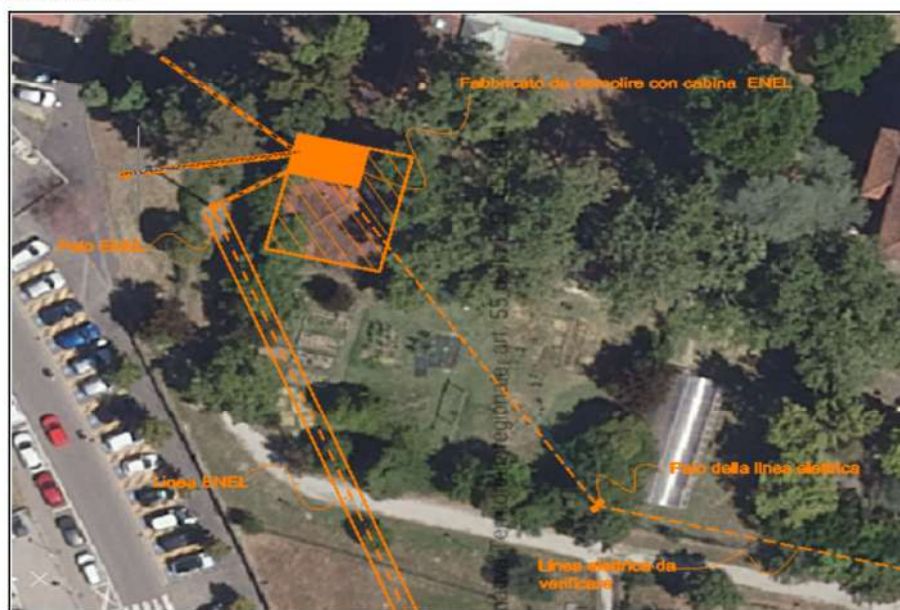
Linee elettriche presenti nell'area di intervento
